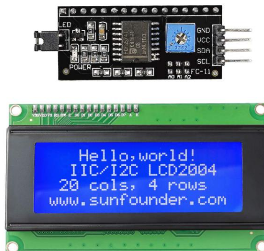
Figure 0.6 : Afficheur LCD 20×4 avec interface I2C.
