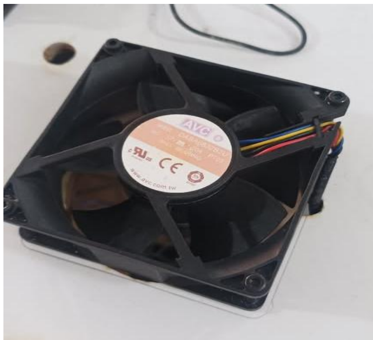
Figure 0.4: Ventilateur DC à commande PWM
