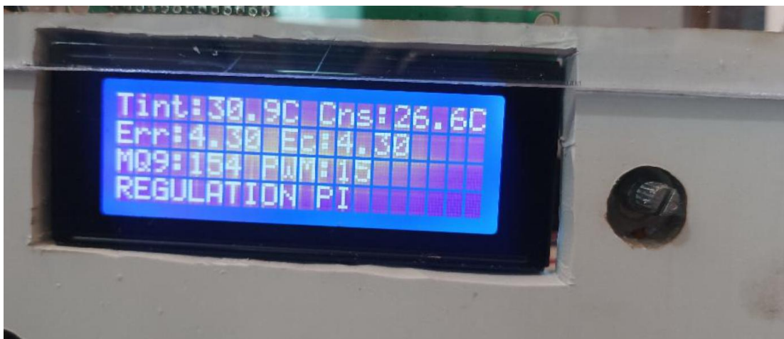
Figure 0.6 : Valeurs réelles de l'essai de protection thermique
