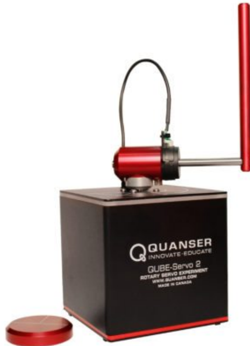
FIGURE II.1 – Plateforme expérimentale Quanser QUBE-Servo 2 avec module pendule rotatif
