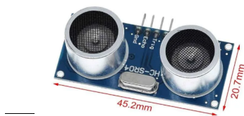
FIGURE 2.15 – Les dimensions du capteur ultrason "HC-SR04", [20].
