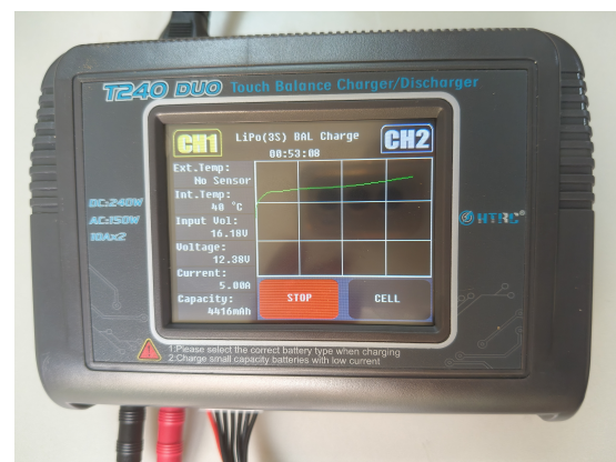
FIGURE 2.22 – Le diagramme de charge de la batterie dans l'afficheur du chargeur HTRC T240
