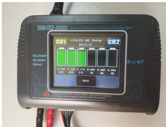
FIGURE 2.21 – Le niveau de charge des trois cellules de la batterie dans l'afficheur du chargeur HTRC T240
