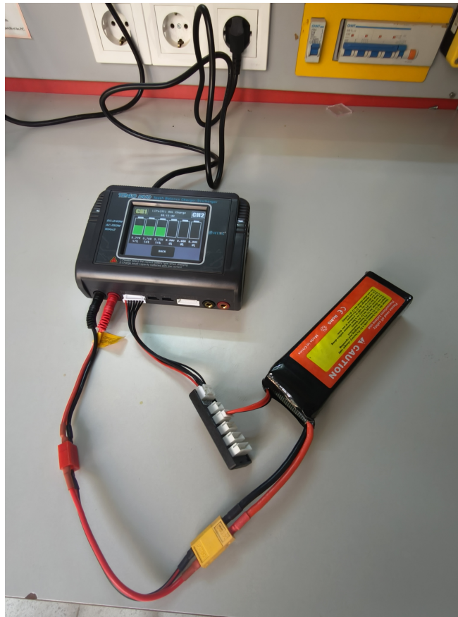
FIGURE 2.20 – La charge de la batterie LiPo en utilisant le chargeur HTRC T240
