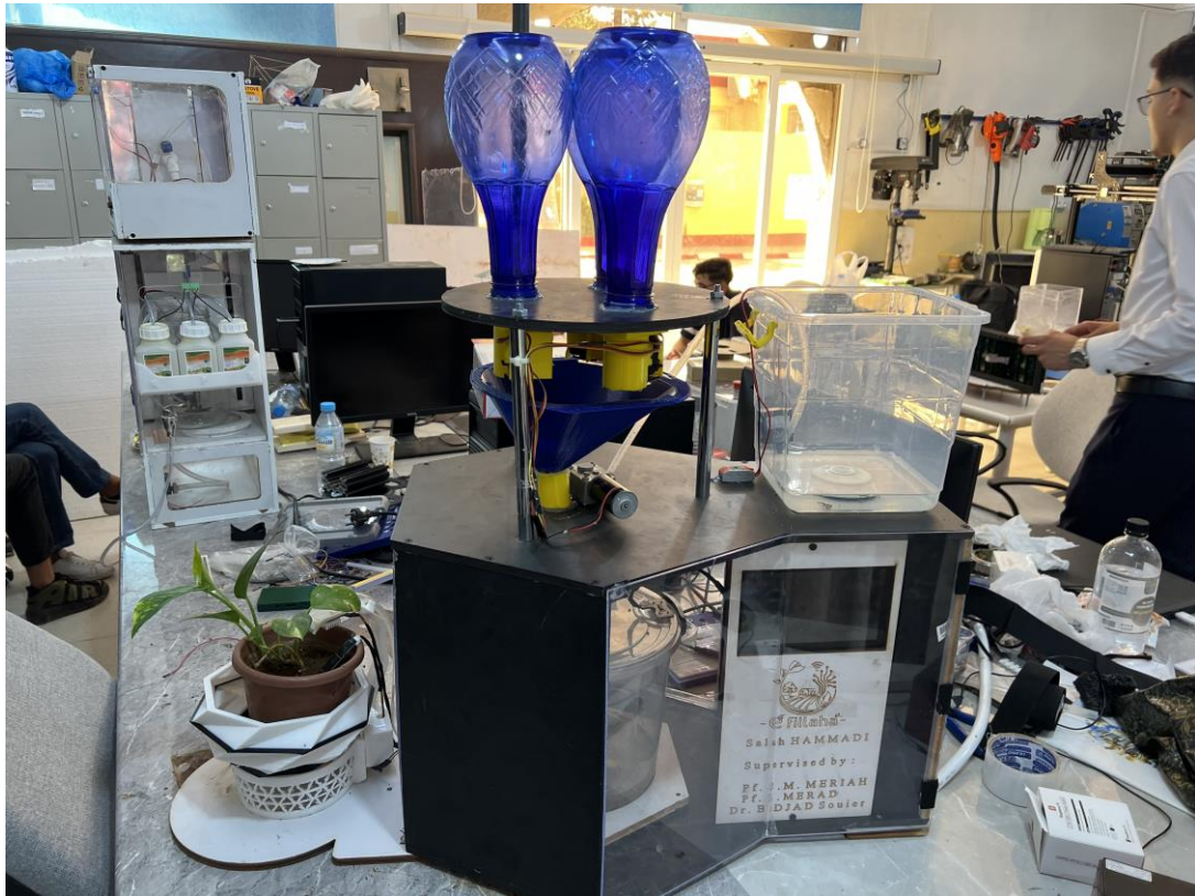
Figure 3.14 : Prototype final assemblé, montrant l'intégration mécanique des réservoirs, du bloc de dosage, de l'entonnoir et du réservoir de mélange.
