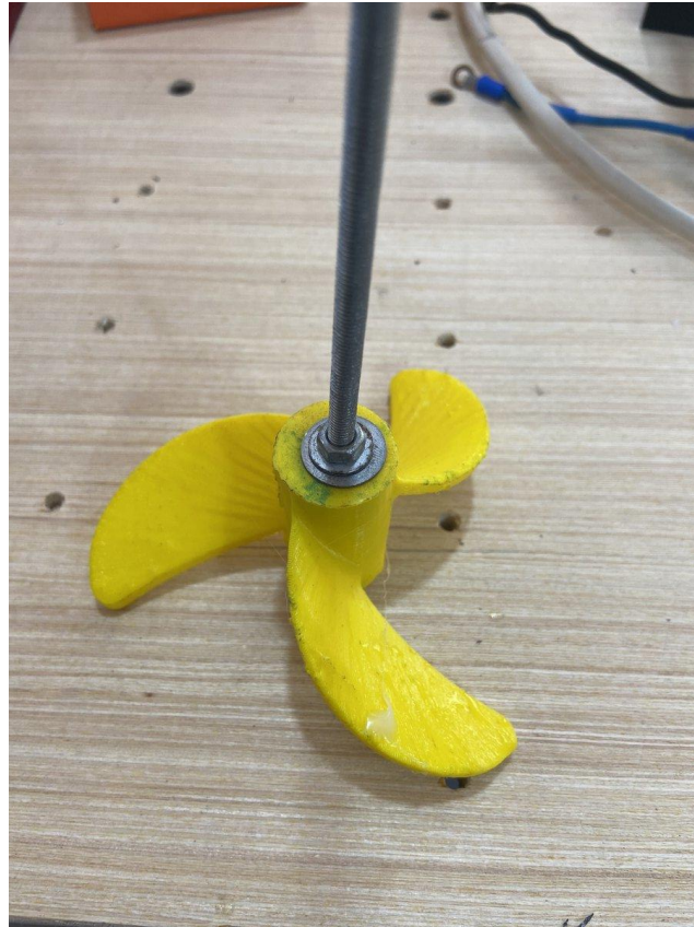
Figure 3.12 : Hélice de mélange à trois pales imprimées en PLA jaune, montée sur la tige d'entraînement avec son écrou de fixation.
