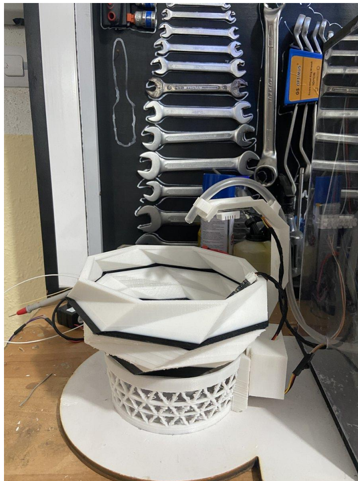
Figure 3.13 : Sous-système d'irrigation pour pépinière réalisé par impression 3D.
