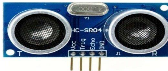
Figure 2.10 : Capteur ultrasonique HC-SR04 utilisé pour la mesure du niveau d'eau dans le réservoir.
