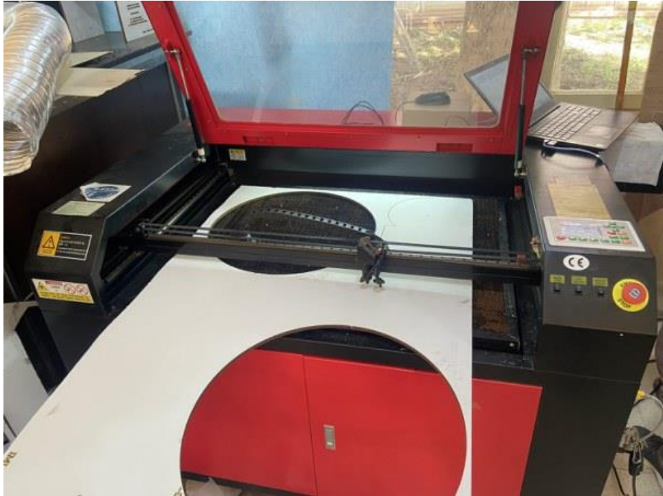
Figure 3.6 : Machine de découpe laser CO 2 utilisée pour la découpe des éléments structuraux plans.
