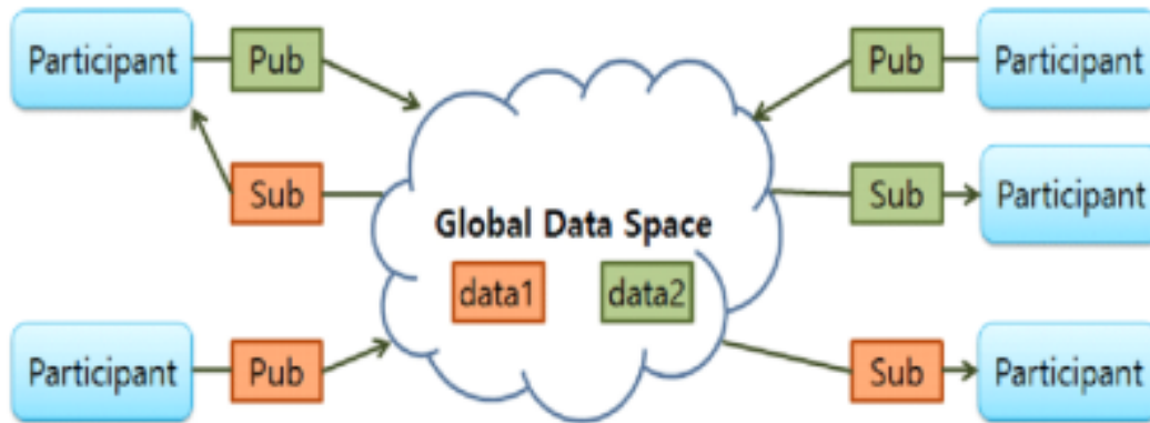
FIGURE 2.5 – Modèle de communication DDS[15].
