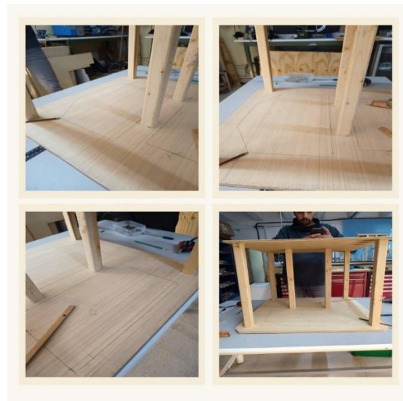
Figure III-6 Fabrication de la première structure du prototype à deux niveaux
