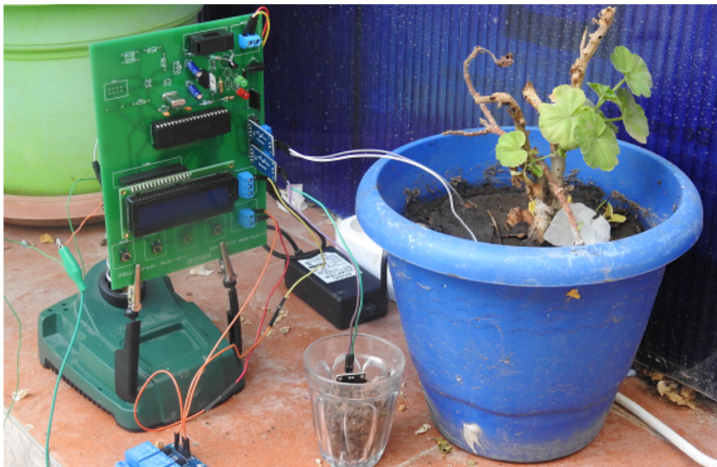
FIGURE 1.8 – Système d'arrosage automatique basé sur des capteurs d'humidité et de température proposé par Megnafi et al. [5]
