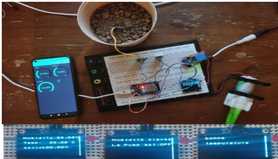
FIGURE 1.8 – Système d’arrosage intelligent propose par Harishankar et al [29].
