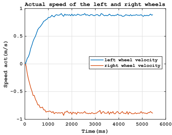
FIG. 3.43 – Robot tourne sur place (sens droite) avec \omega = 4rd/s et v = 0
