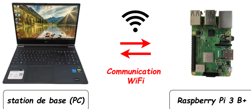
FIG. 3.15 – Schéma de la communication entre le PC et le Raspberry Pi
