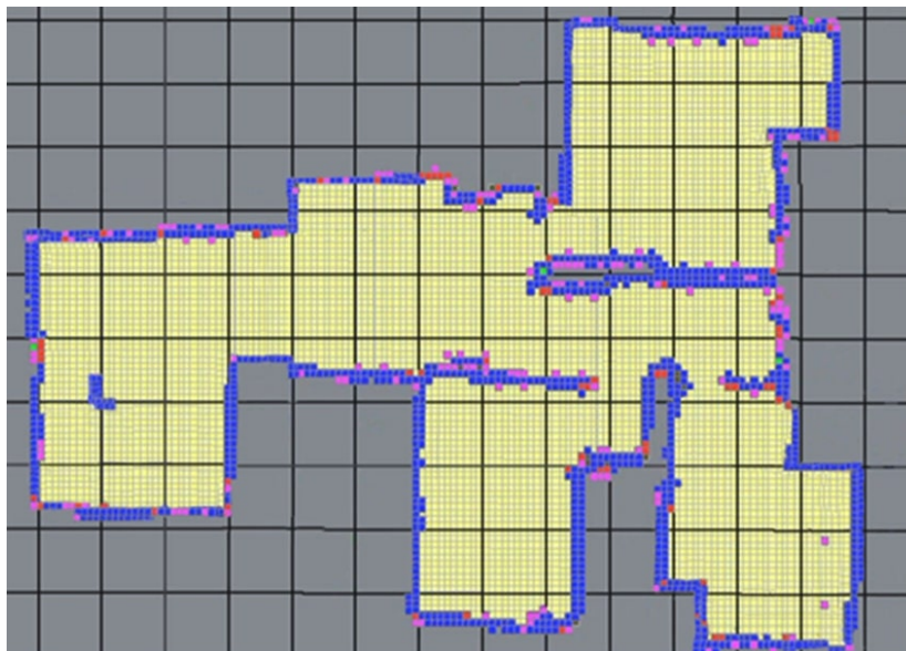
FIG. 1.33 – Carte en grille construite avec grid-based SLAM [30]
