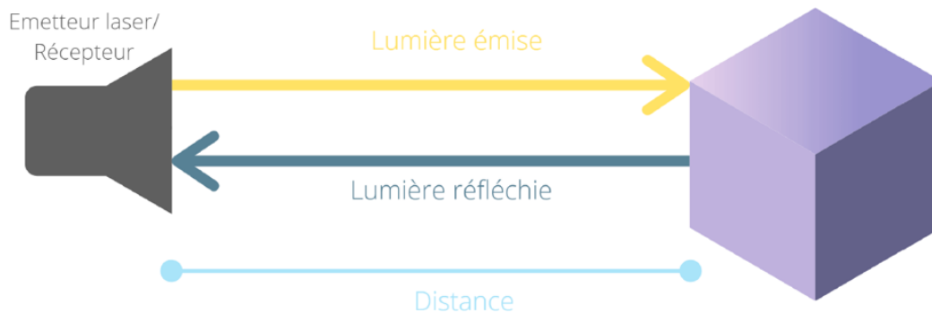
FIG. 2.16 – Principe de fonctionnement du LiDAR [25]
