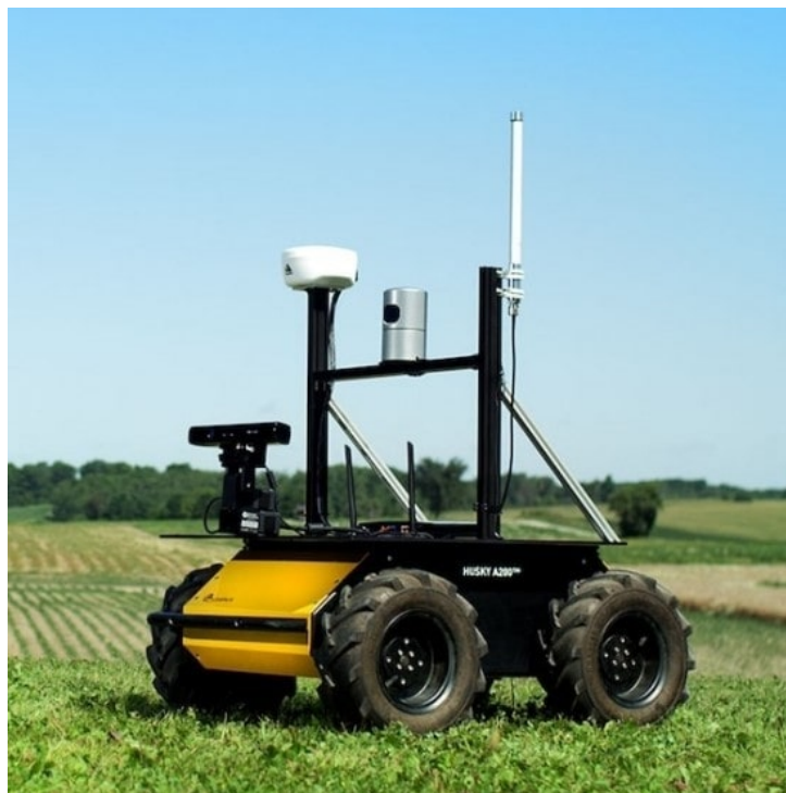
FIG. 3.2 – Robot Husky équipé de caméras, LiDAR, GPS
