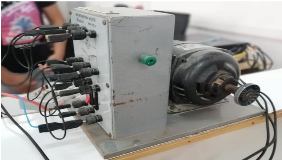
Figure 4.4-4 Photo du moteur asynchrone
