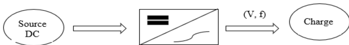
Figure 2.1. Schéma simplifié d'onduleur
