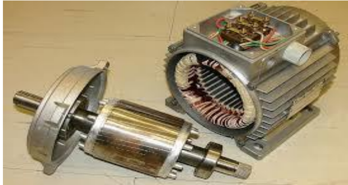
Fig. I.3 : Stator (à droite) et rotor (à gauche) du moteur à courant continu.
