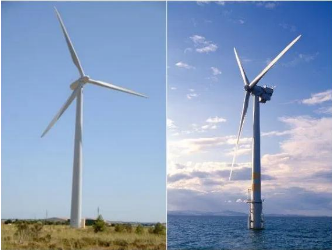
Figure (I.14) : Aérogénérateur à axe horizontal [22].
