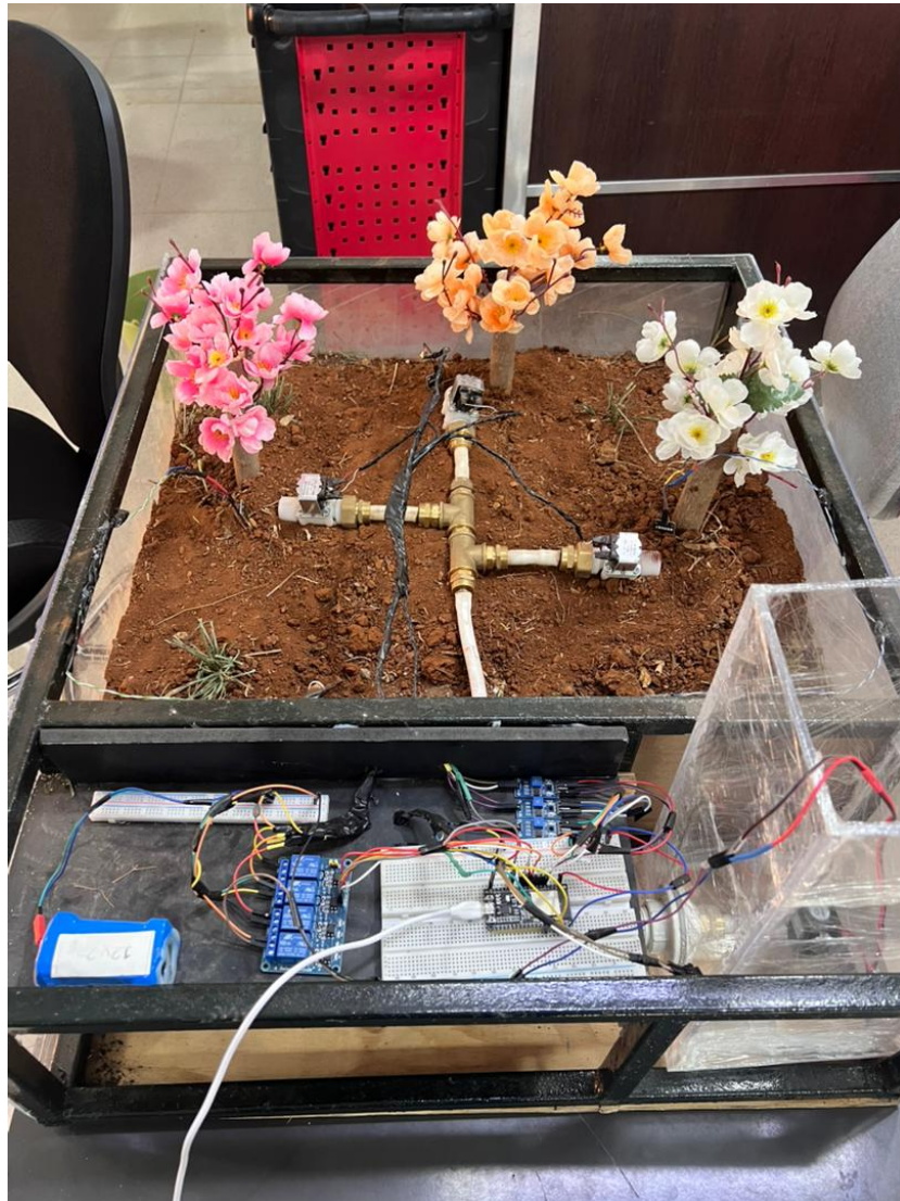
Figure 2.1: Architecture générale du système d'arrosage intelligent
