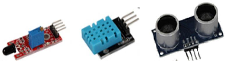
Figure 6. Exemple des capteurs utilisés avec la carte Arduino
