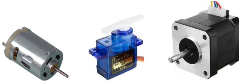
Figure 7. Exemple des actionneurs utilise avec la carte Arduino
