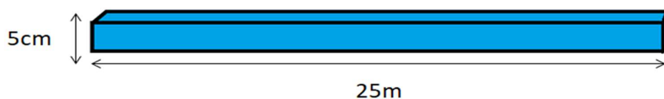
Figure 30 : chemin de câble fermé
