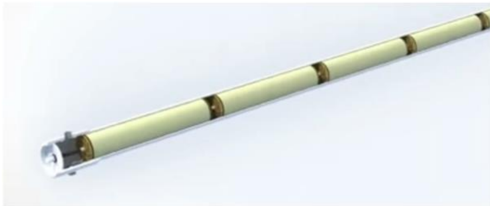
Figure I-6:un tube de pression d'une unité de filtration [16]
