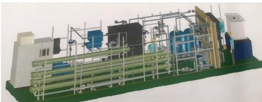
Figure I-4:Intérieur de la station de traitement de lixiviat [3]
