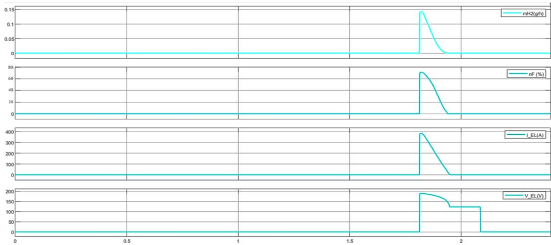
FIGURE 4.4 – Tension courant et taux de production hydrogène et le rendement faradique de l'électrolyseur alcaline
