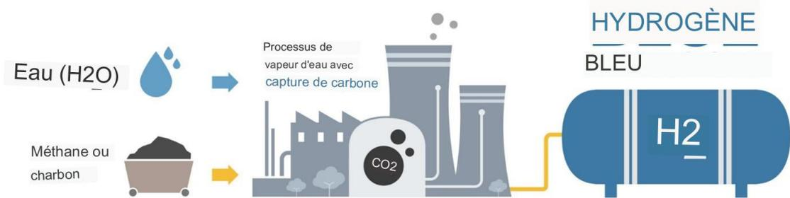
FIGURE 1.5 – Principe de production de l'hydrogène bleu
