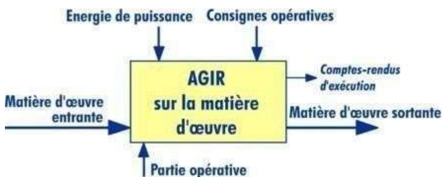
Figure 1-5 : Structure de la partie opérative [7]
