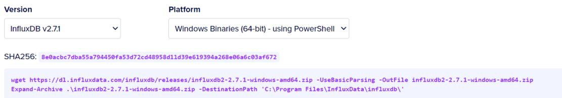
Figure 3.1 – Les commandes d'installation
