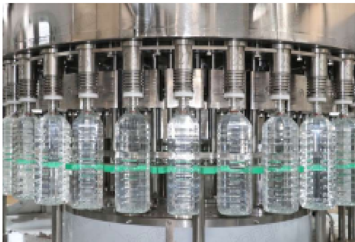
Figure 1.34: Système de Remplissage [3]
