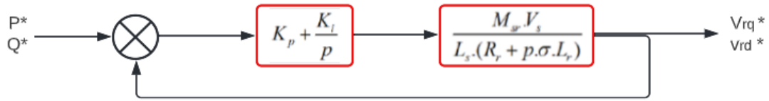
FIGURE 2.9 – Schéma de régulation des puissances P_s et Q_s
