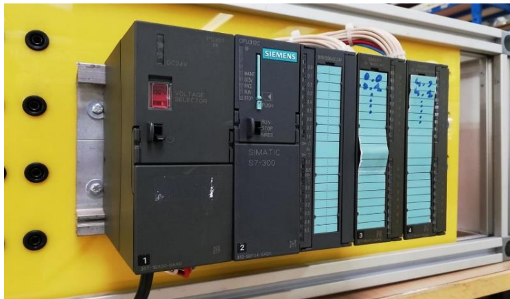
Figure III. 2: PLC de forme modulaire(combiné) [26].
