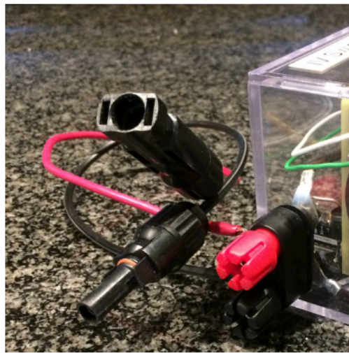
FIGURE 3.8 – Bornes de reliure et câbles PV.
