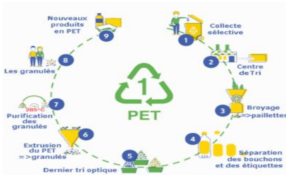
Figure 1.14 : processus de recyclage de PET
