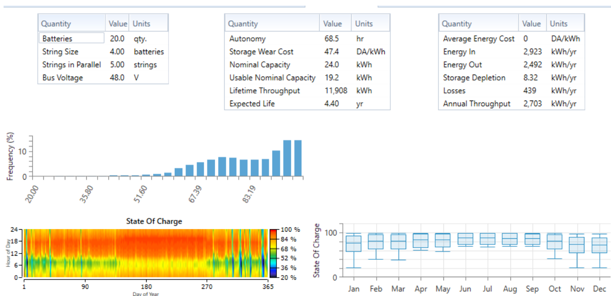
Figure IV. 23: Etat de la charge moyenne journalière et mensuelle des batteries pour système autonome.
