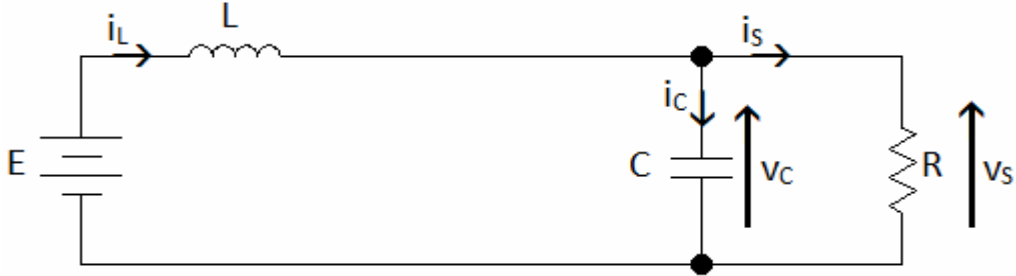
Figure II.3 : Schéma du hacheur boost quand l'interrupteur est ouvert
