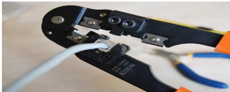
Figure 1.2 Sertissage d'un câble à paires torsadées
