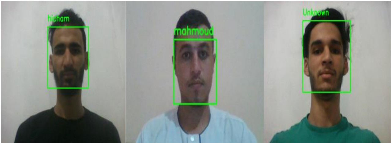
Figure 4-10 : Reconnaissance faciale avec l'architecture de CNN MobileNetV2 avec une personne non-reconnue.
