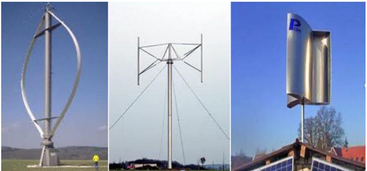
FIGURE 1.17 – Turbine de type : Darrieus classique, Darrieus (type H) et Savonius .
