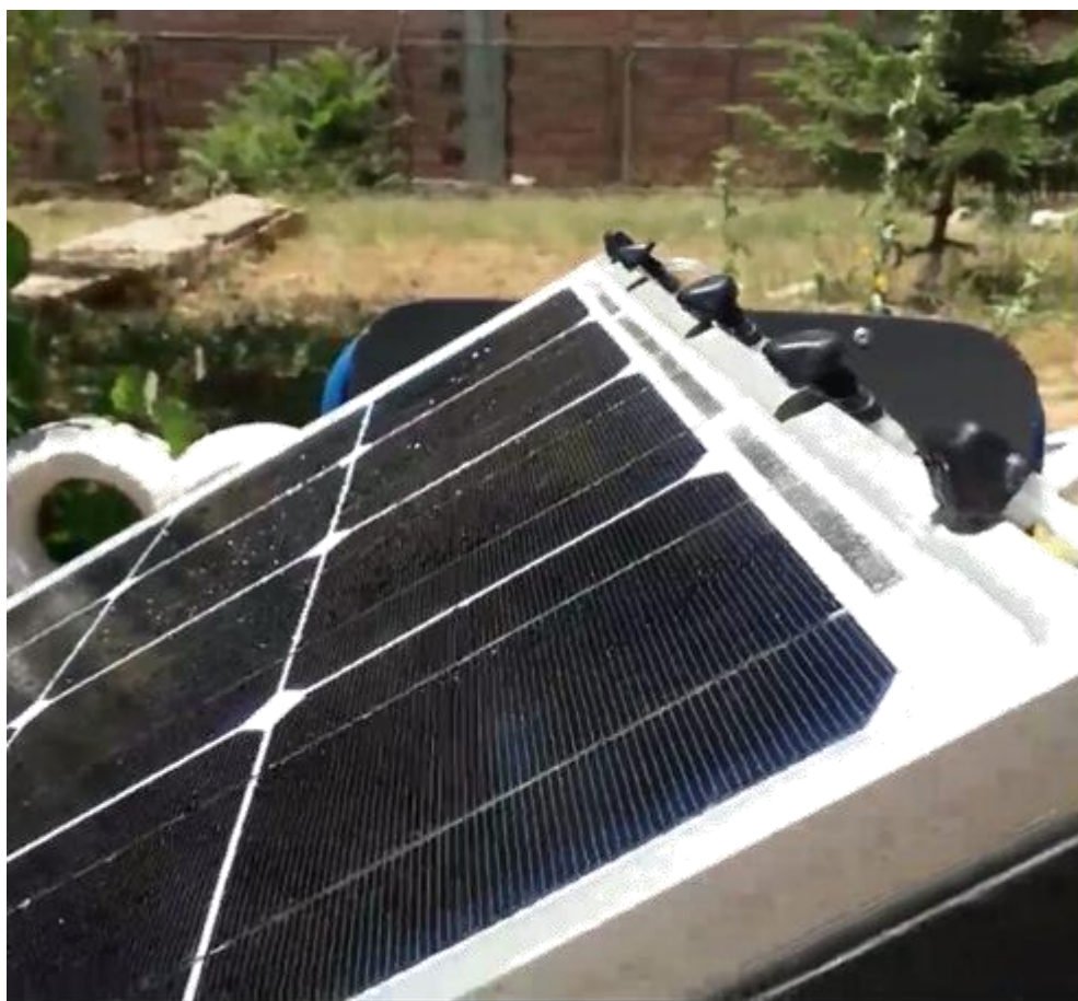
Figure III-15 Le système de refroidissement par pulvérisation d'eau
