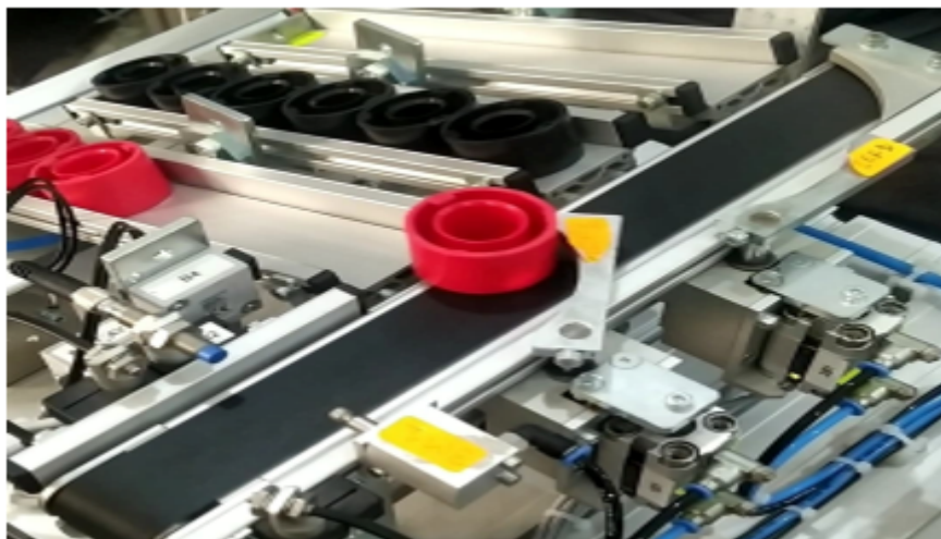
FIGURE 2.44 – Module de dérivation de la station.
