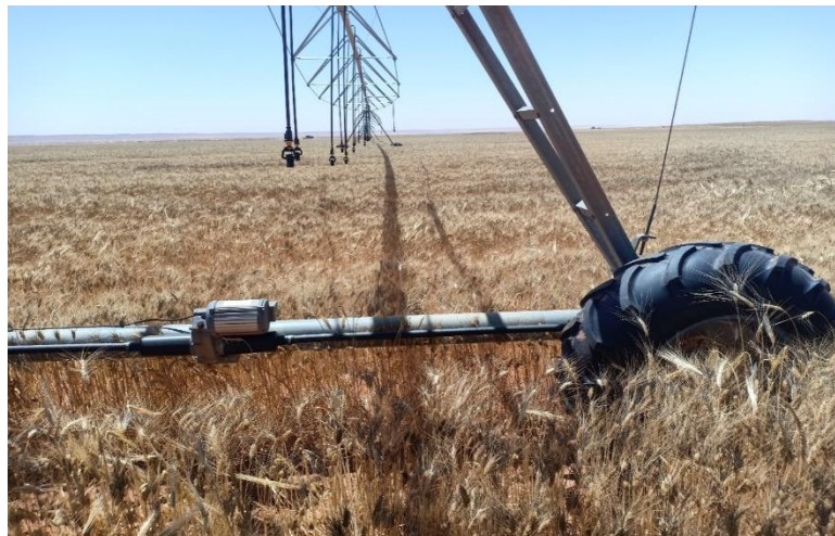
Figure 3. 25 : les deux roues qui sont alimentées par le moteur et font tourner le pivot
