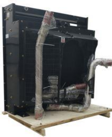
Figure1. 17 : Système de refroidissement du moteur*[12]
