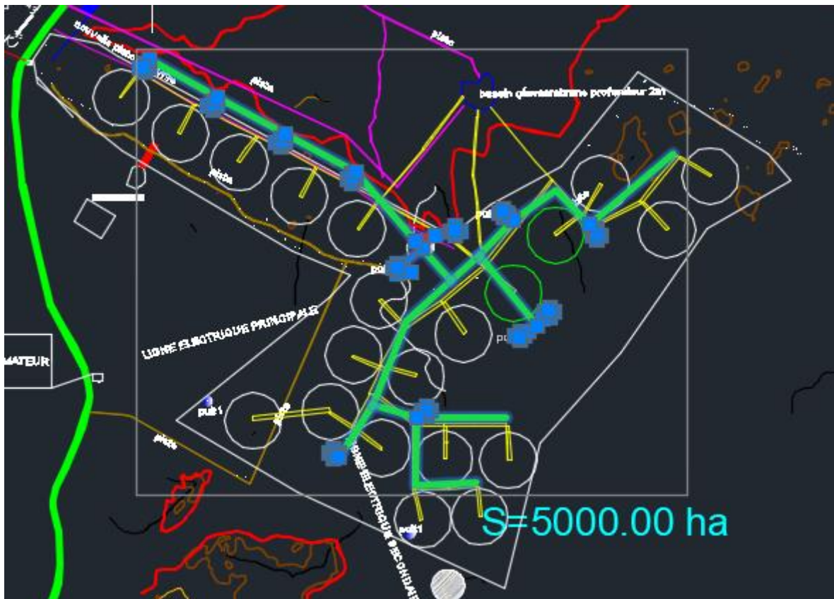
Figure 2. 14 : proposition du réseau électrique
