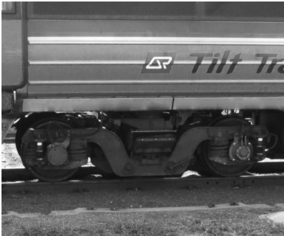
Figure 1.8 : Bogie pour wagon de passagers [9]
