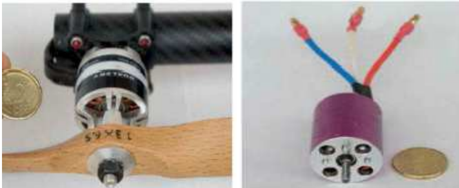
Figure I. 17 : moteur à cage tournante à gauche et fixe à droite.
