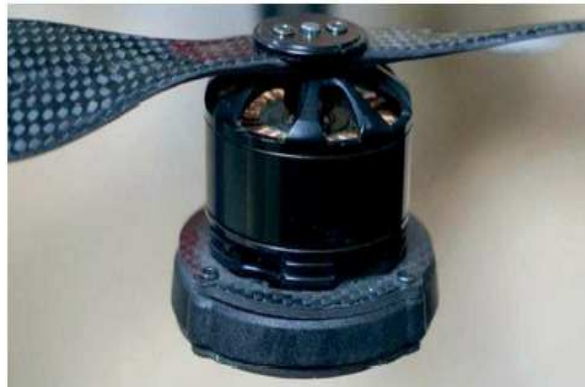
Figure I. 15 : Contrôleur brushless d'un DJI S800 situé en extrémité du bras, sous le moteur.
