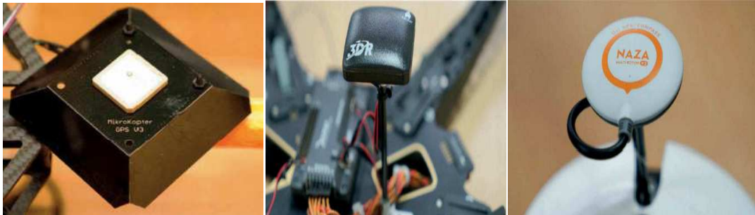
Figure I. 11 : a) module GPS d'un drone Micro Kopter, b) Antenne GPS 3DR, c) Antenne GPS DJI.
