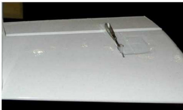
Figure I. 12 : Gouverne d'ailerons on devine la forme rectangulaire d'un servo intégré dans l'aile.
