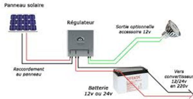
FIGURE 2.4 – Fonctionnement d'un régulateur de charge [4].
