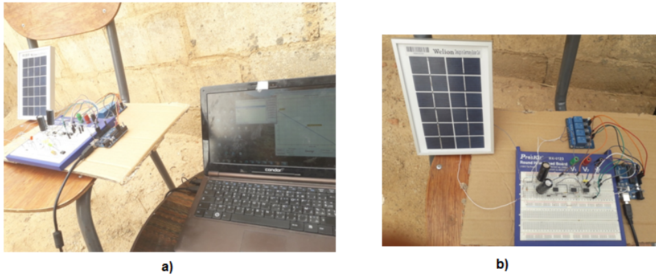
FIGURE 3.20 – L'ensemble du montage : Ordinateur, circuit du traceur IV swinger et un panneau d'essai sous exposition au soleil.
