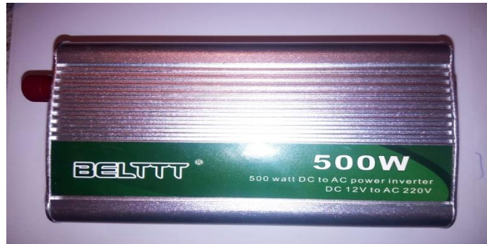
Figure III-16 Onduleur monophasé 500W
