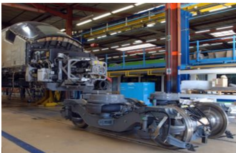
FIGURE 1.9: Bogie au cours de construction.
