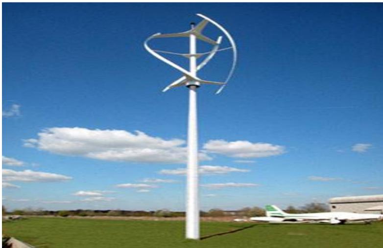
**Figure I.6 : Eolienne a axe vertical Darrieus.**
