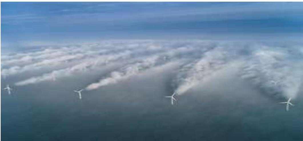
Figure II.9: Effet de sillage d'un parc éolien en mer.
