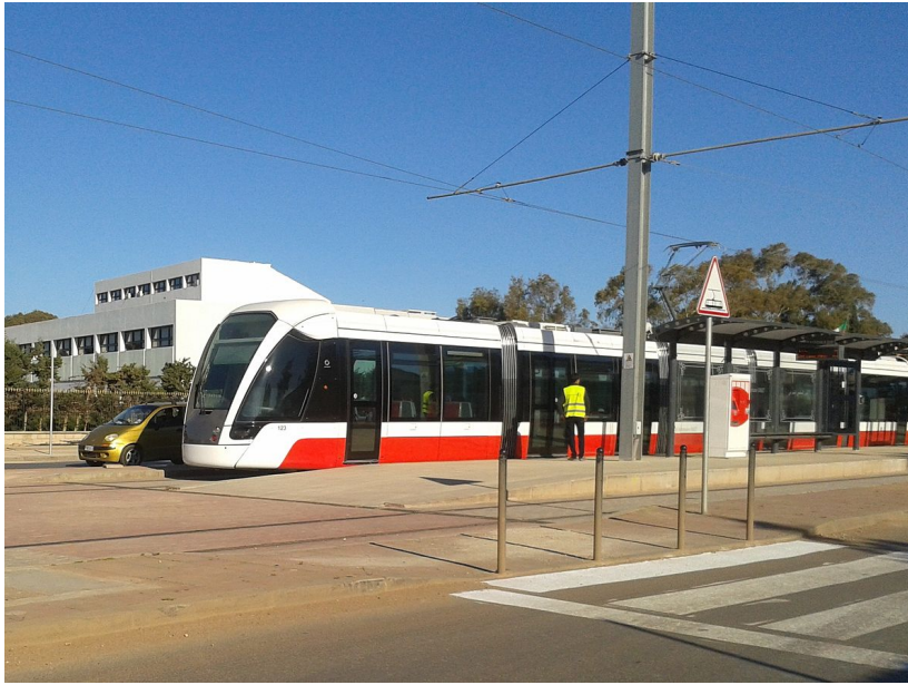
FIGURE 3.38: L'insertion d'un poteau axial.
