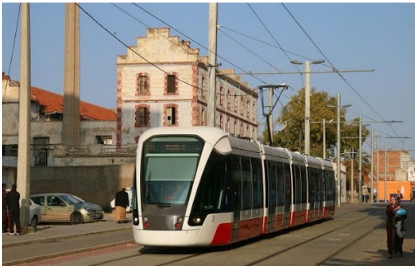
FIGURE 3.39: Insertion d'un poteau latéral
