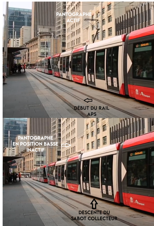
FIGURE 3.27: Changement de mode d'alimentation au niveau d'une station
