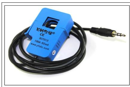
FIGURE 3.4: Le capteur de courant SCT 013000.
