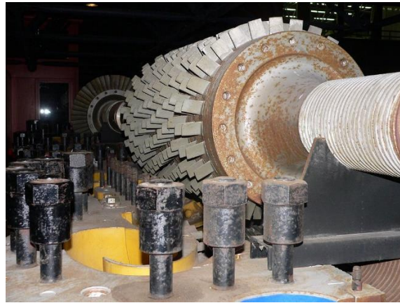
Figure 2-6 Turbine à gaz utilisée dans la propulsion d'un navire [25].
