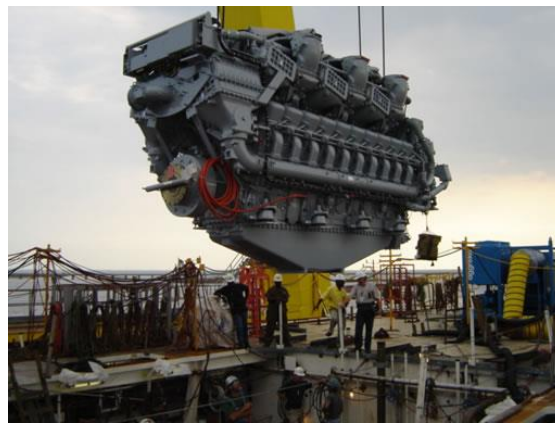
Figure 2-5 L'installation d'un moteur diesel dans un navire [24].
