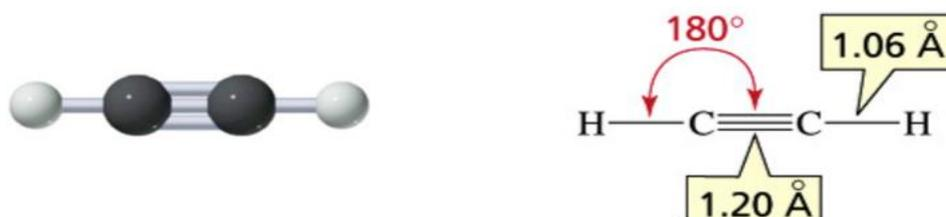
Figure 18: Longueurs des liaisons et angles dans l'acétylène
