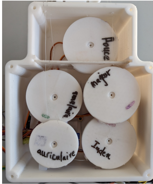
FIGURE 2.25 – Poulies assemblées aux servomoteurs
