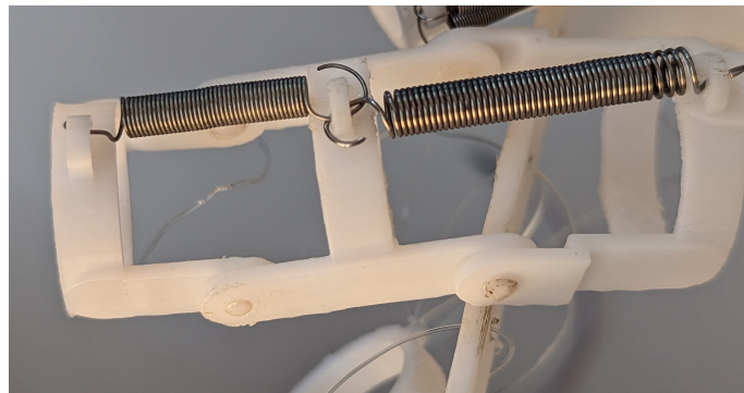
FIGURE 2.27 – L'attache des ressorts entre les phalanges des doigts
