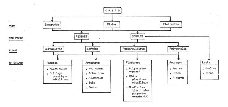
Figure II. 3 les types des cages flottantes
