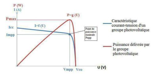
Figure I. 3: Caractéristique puissance-tension.
