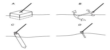
Figure II. 18:Différentes ancres sont utilisées pour l'amarrage des cages à la mer : bloc (poids mort) (A), ancre de reflux (B), pieu (C), boulon(D).
