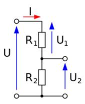
Figure III. 9: schéma de deviseur de tension
