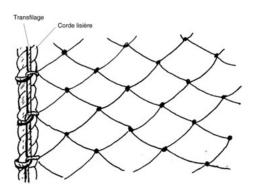
Figure II. 2 : Montage du bord d'une nappe de filet
