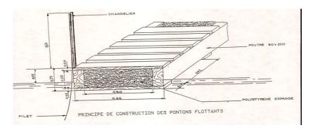
Figure II. 13: Passerelle d'une cage flottante traditionnelle
