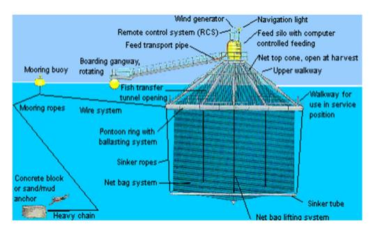
Figure II. 4 : Démonstration d'une cage Farmocean (Farmocean International).
