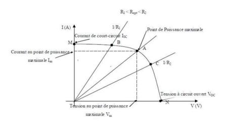
Figure I. 2: Caractéristique courant – tension d'une cellule photovoltaïque.
