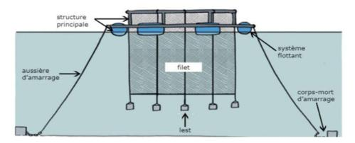
Figure II. 5 : Image démontrant les principaux composants d'une cage PE-HD (FAO)
