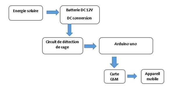
Figure III. 2: schéma de principe de système de surveillance
