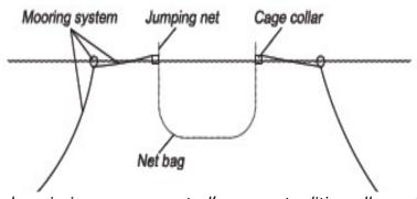
Figure II. 11: les principaux composants d'une cage traditionnelle en plein mer
