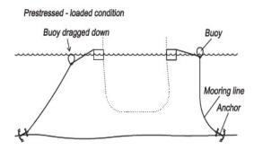
Figure II. 17: Les systèmes d'amarrage (précontraint et mou)
