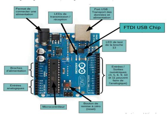
Figure III. 4: la carte électronique Arduino uno
