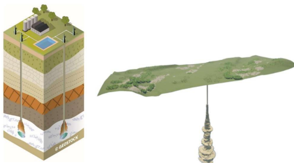
Figure 13: Stockage en cavité saline[9]
