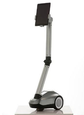
FIGURE 1.19 – Robot de téléprésence [35]
