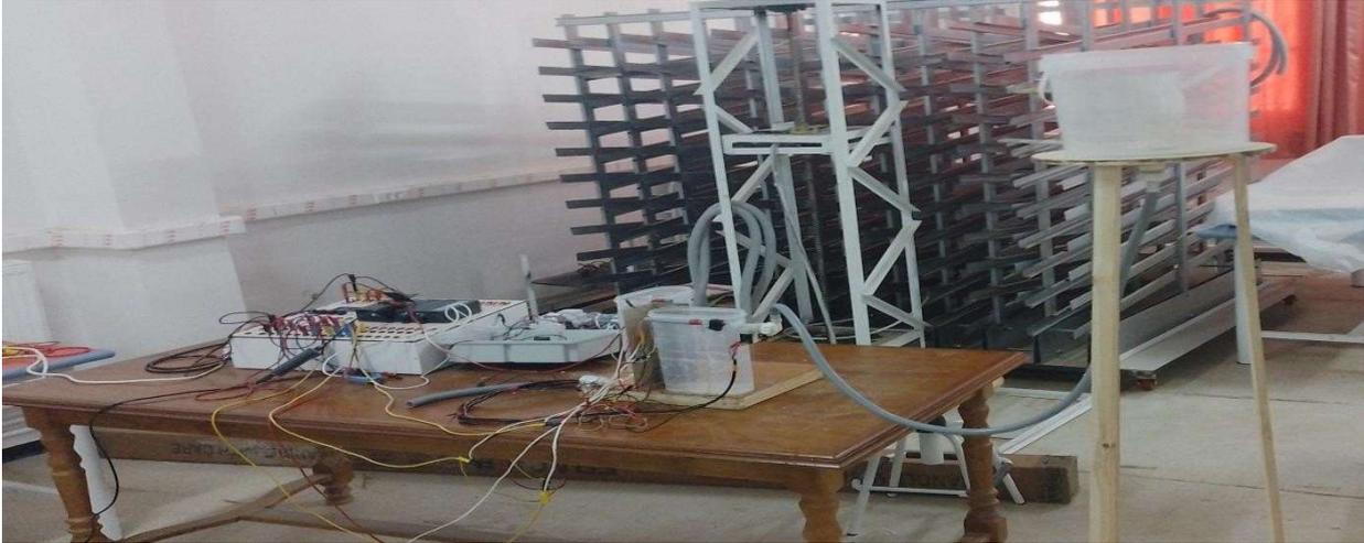
**Figure 3.6** : câblage des entrées et sorties de l'API à l'ensemble de notre système
