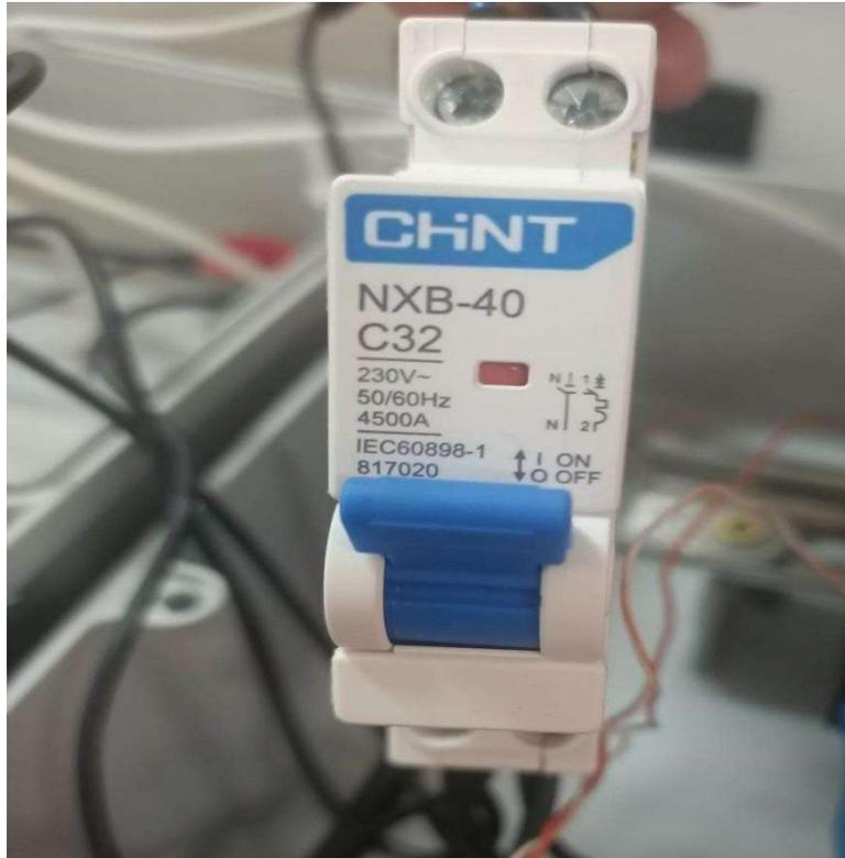
**Figure 2.14** : Protection bipolaire électrique.
