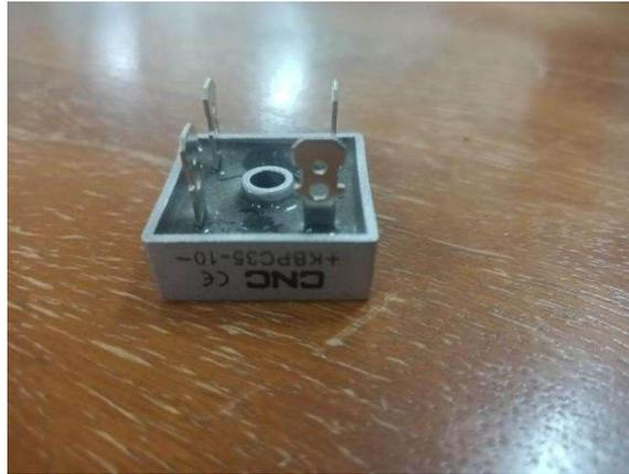
Figure 2.23 : pont de diode
