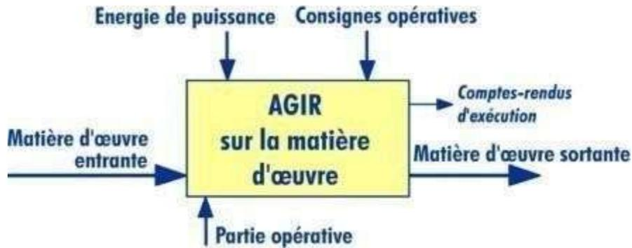
Figure 1.5: Structure de la partie opérative [7]
