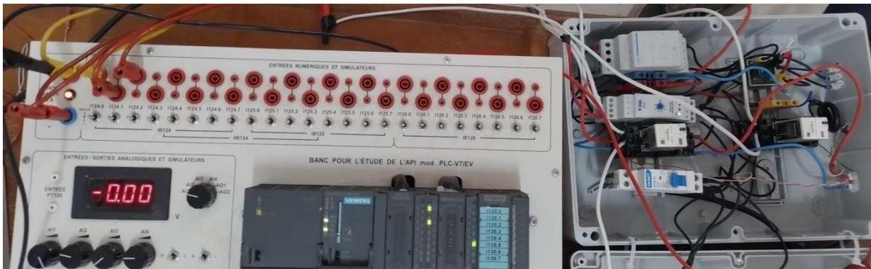
**Figure 3.7** : câblage des entrées de l'API à notre système
